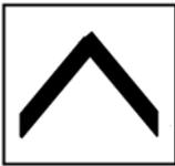
Le chevron pointe en haut est placé en talon de l'aiguille de sortie à gauche de la voie à laquelle il s'adresse (disposition inverse sur les sections de ligne à double voie où la circulation se fait normalement à droite).
