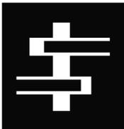
Le pictogramme « Baissez panto » commande au conducteur d'abaisser le ou les pantographes.
