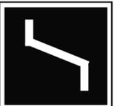
Indique que la circulation en provenance d'une ICS est dirigée à sens normal. Sur les sections de ligne où la circulation se fait normalement à droite, indique que la circulation est dirigée à contresens.
