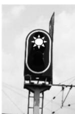
Utilisé exclusivement en signalisation lumineuse, le feu blanc clignotant commande ou confirme au conducteur l'observation de la marche en manoeuvre et lui indique que le carré violet correspondant n'est ouvert que pour l'exécution d'une manoeuvre sur un parcours généralement de faible longueur.
