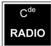
Repère le point où la commande par radio de la fermeture des barrières du PN à SAL FC doit être effectuée.
