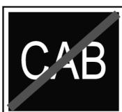
Un tableau « CAB » barré d'un trait rouge ou provisoirement « Fin TGV », à lettres blanches sur fond noir indique que la circulation va sortir d'une ligne à signalisation en cabine.
