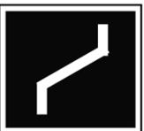
Indique ou confirme que la circulation est dirigée à contresens sur une installation de contre-sens (ICS). Sur les sections de ligne où la circulation se fait normalement à droite, indique que la circulation en provenance d'une ICS est dirigée à sens normal.
