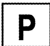
Ce tableau, éclairé la nuit et muni d'un dispositif permettant la répétition dans les cabines de conduite, de forme carrée, présente la lettre « P » en noir sur fond blanc.
