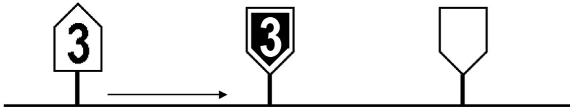
Le TIV à distance, ainsi que le TIV d'exécution, commande au conducteur des trains concernés de ne pas dépasser la vitesse indiquée sur le tableau, en dizaine de kilomètres à l'heure, au franchissement de la partie de voie intéressée.
