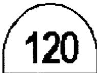
Ce tableau, éclairé la nuit ou réflectorisé et non muni d'un dispositif permettant la répétition dans les cabines de conduite, en forme de demi-cercle, courbure en haut, indique en kilomètres à l'heure, en chiffres noirs sur fond blanc, la vitesse à ne pas dépasser par les trains concernés.
