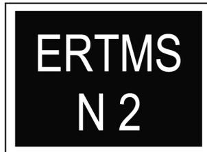
Ce tableau indique au conducteur le point de transition de type de signalisation en cabine.
