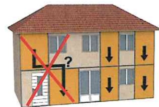
Absence de transmission directe des efforts : non admis en maçonnerie et en béton armé, sous réserve pour les structures métalliques ou bois
