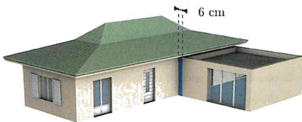
Exemple de conception d'un joint pour satisfaire au critère 2 : pas de retrait supérieur à 10% de la surface de plancher
