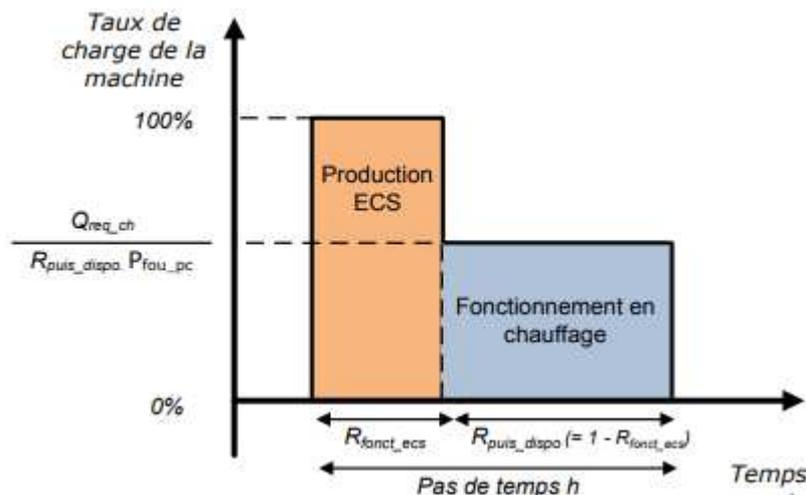
Au début du pas de temps,  $id\_fonction = 3$  : la machine est en mode de fonctionnement ECS.
