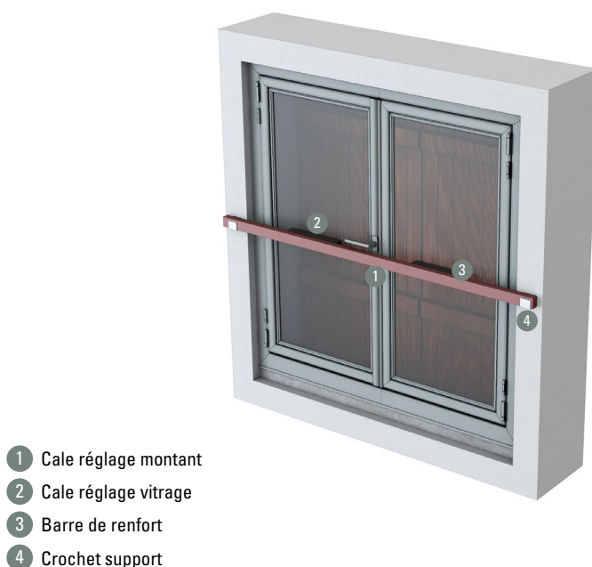
Figure 134 : Principe de fenêtre renforcée
