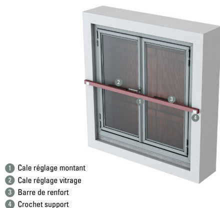
Figure 127 : Renfort de fenêtre
